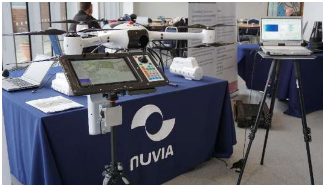
Systém pro dálkové měření radioaktivity NUVIA (foto NUVIA)
