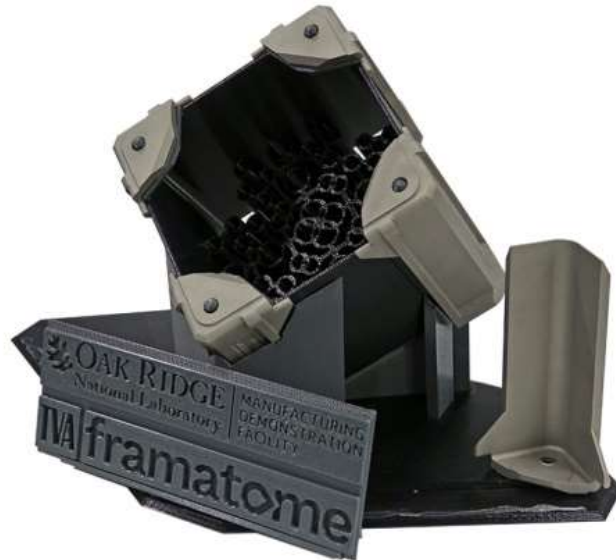
Aditivně (3D tisk) vyrobený spojovací prvek kanálu (Obrázek: ORNL)
