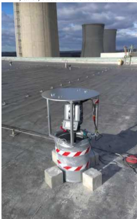
Vnější a měření deformací hermetického boxu při pevnostní zkoušce
