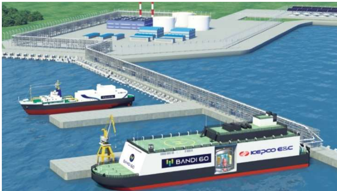
Plovoucí jaderná elektrárna založená na reaktoru BANDI-60 (Obrázek: Kepco E&C)
